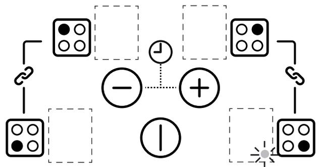
L'indicateur de minuterie à l'écran cesse de clignoter et ne s'affiche pas. Le fonctionnement d'une minuterie est indiqué par un point fixe dans l'affichage de la zone de cuisson pour la zone de cuisson minutée.
