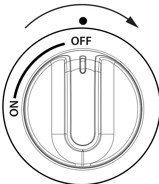
La fonction de réchauffement peut être activée en tournant le bouton de commande sur la position «On».
