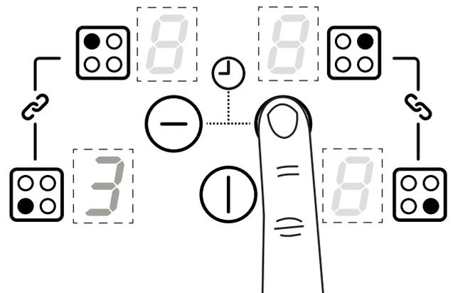
Remarque: Appuyez d'abord sur la touche moins pour régler automatiquement le niveau de puissance au niveau 9. Lorsque la sélection de la zone de cuisson est terminée au bout de 10 secondes, un bip retentit et tous les affichages du radiateur qui ont été atténués indiquent les niveaux de puissance avec une luminosité normale.
