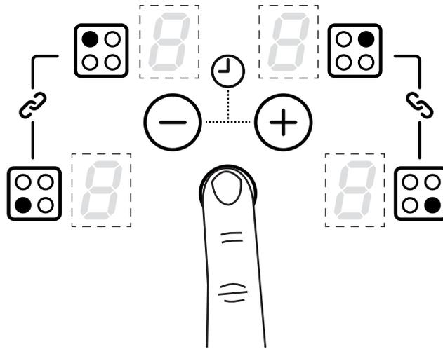
Remarque: Si aucune zone n'est sélectionnée dans les 10 secondes, la table de cuisson s'éteint automatiquement. La table de cuisson s'éteint en appuyant sur la touche «ON / OFF» pendant 1 seconde. Un bip retentit et tous les foyers s'éteignent.
