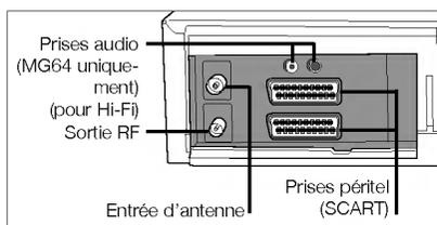
**i** Vous devez utiliser un câble coaxial et un câble SCART pour raccorder votre magnétoscope à votre TV.
