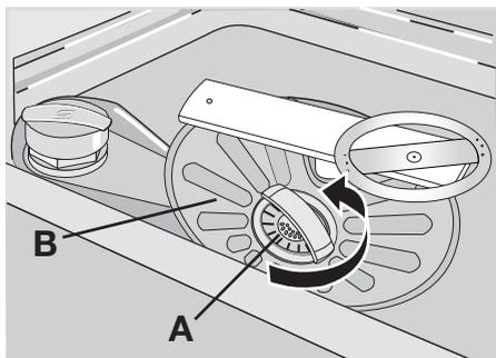
2. Le filtre (A) est composé de 2 pièces. Pour démonter le filtre, séparez-les.
