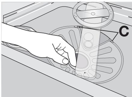
8. Mettez le filtre (A) en place dans le filtre (B). Bloquez le filtre (A) en tournant la poignée dans le sens des aiguilles d'une montre jusqu'à la butée.
