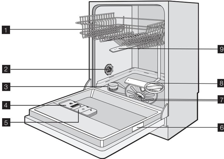
**1** Panier supérieur**2** Sélecteur de dureté de l'eau**3** Réservoir à sel régénérant**4** Distributeur de produit de lavage**5** Distributeur de liquide de rinçage**6** Plaque signalétique**7** Filtres**8** Bras d'aspersion inférieur**9** Bras d'aspersion supérieur
