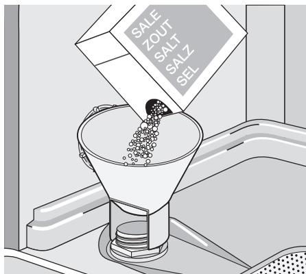
**i** Il est normal que de l'eau s'écoule du réservoir lorsque vous le remplissez de sel.
