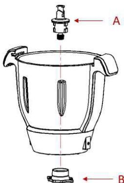
Afin de démonter l'axe, sortez le bol de sa base puis tourner-le. Dévissez dans le sens inverse de l'aiguille d'une montre le verrou. Et dans le sens des aiguilles d'une montre pour le visser.
