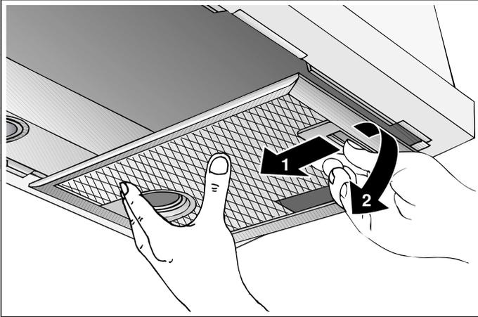
2. Sortez le filtre à graisse métallique de sa fixation.
