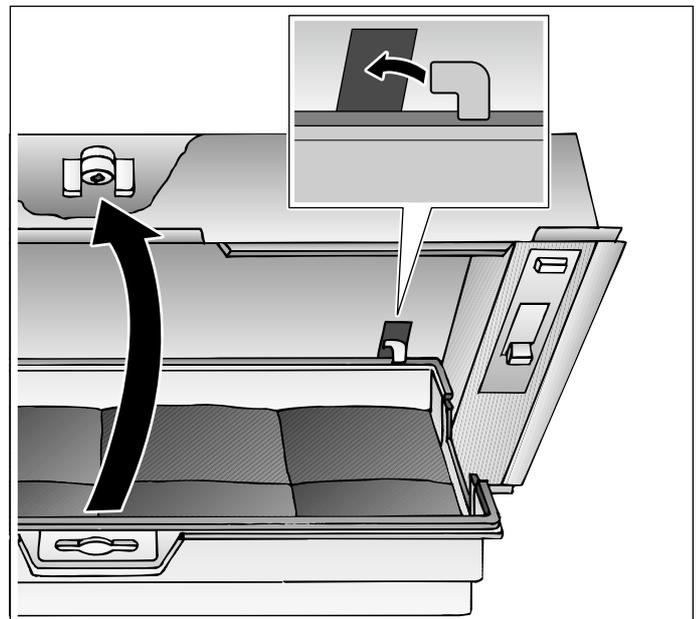
6. Remettez le filtre à graisse métallique en place.
