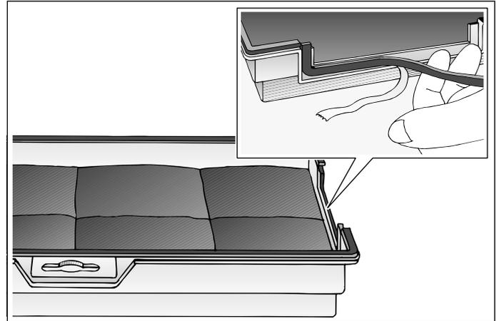
5. Insérez le filtre au charbon actif à l'arrière et basculez-le vers le haut, puis verrouillez-le avec l'écrou à oreilles au milieu. Sur les appareils dotés de rails d'écartement, remettez ces derniers en place.
