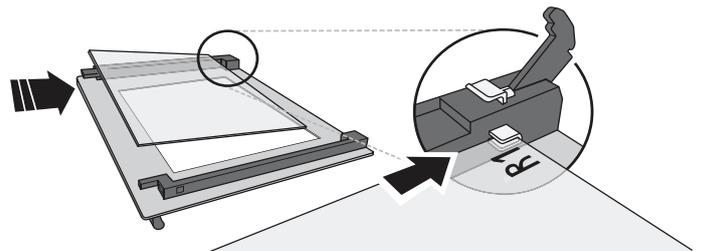
**4.** Remplacez le bord supérieur : un déclic indique le positionnement correct. Assurez-vous que le joint est bien placé avant de replacer la porte.
