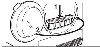
1) Si nécessaire, retirez les peluches du logement et du joint du filtre. Vous pouvez utiliser un aspirateur.
