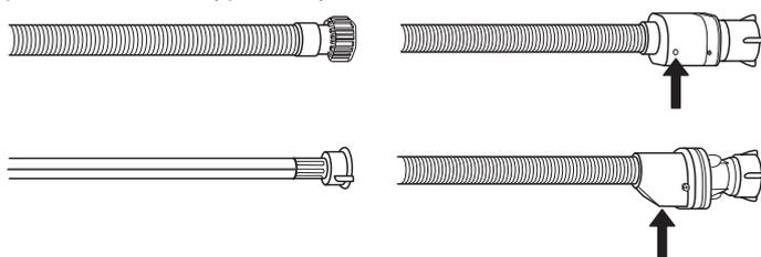
Si le tuyau d'arrivée a un revêtement transparent, vérifiez si la couleur est plus prononcée à certains endroits. Si c'est le cas, il pourrait y avoir une fuite et il doit être remplacé.
