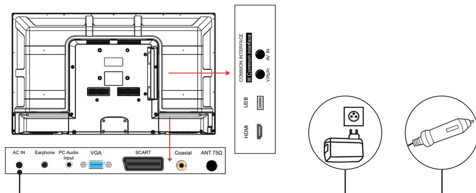
Branchez une extrémité du câble d'alimentation ou du cordon allume-cigare sur le connecteur d'alimentation AC IN situé au dos du téléviseur. Puis branchez l'adaptateur secteur sur une prise murale ou sur la prise allume-cigare de votre véhicule. Le témoin lumineux du téléviseur s'allume en rouge. L'appareil est alors prêt à fonctionner.
