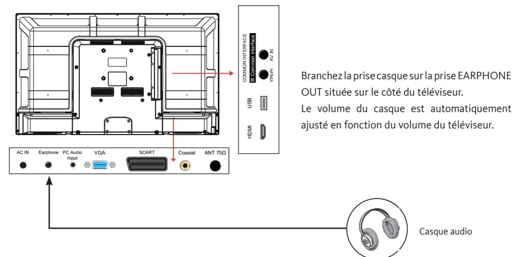
Branchez la prise casque sur la prise EARPHONE OUT située sur le côté du téléviseur. Le volume du casque est automatiquement ajusté en fonction du volume du téléviseur.
