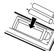
Positionnez les piles dans le boîtier en respectant les indications de polarité « + » et « - » indiquées.
