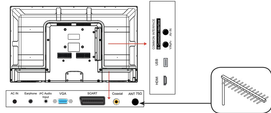
Afin d'obtenir la meilleure qualité d'image par voie hertzienne, il est fortement recommandé d'utiliser une antenne extérieure. Raccordez l'antenne à la prise d'entrée de l'antenne située au dos du téléviseur. La qualité de l'image varie en fonction de la qualité de votre réception.
