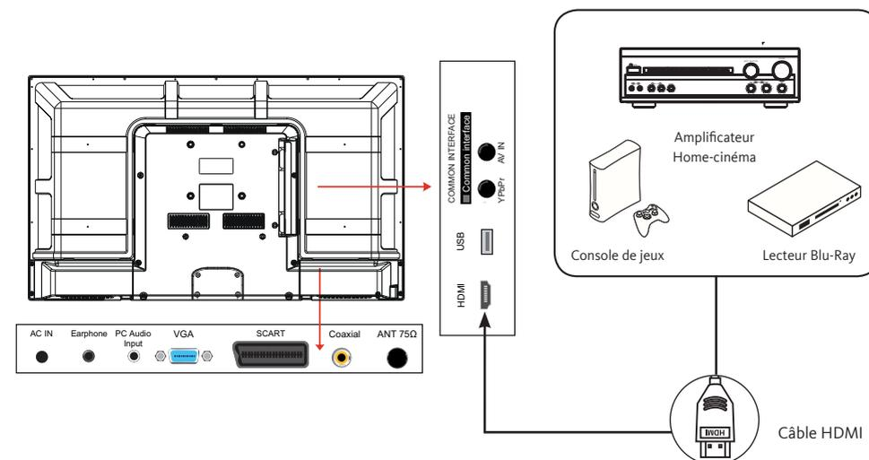
La connexion HDMI achemine des signaux exclusivement numériques. Si votre appareil (Lecteur DVD, boîtier décodeur...) est équipé d'une prise HDMI, nous vous conseillons d'utiliser ce mode de branchement afin d'obtenir une qualité vidéo optimale.
