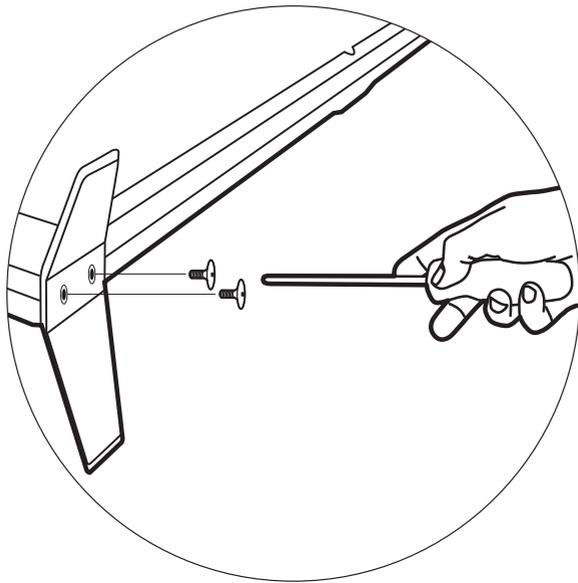
3. Utilisez un tournevis pour serrer les deux jeux de vis sous chaque pied. Ne serrez pas exagérément, pour éviter d'endommager les parties en plastique.
