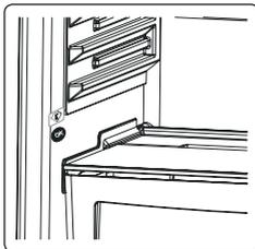
La limite supérieure de la zone la plus froide est indiquée par la base inférieure de l'autocollant (pointe de la flèche). La clayette supérieure de la zone la plus froide doit être au même niveau que la pointe de la flèche. La zone la plus froide se situe en-dessous de ce niveau.
