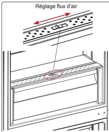
Si le compartiment à légumes est plein, le réglage flux d'air situé à l'avant du compartiment doit être ouvert. Ceci permet la pénétration de l'air dans le compartiment à légumes et le contrôle du taux d'humidité afin d'augmenter la durée de vie des aliments.
