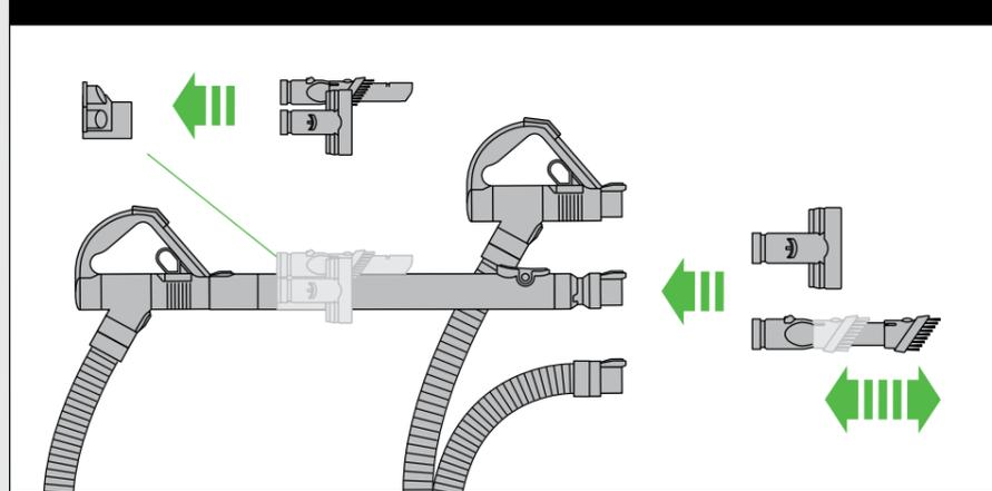
Suction release. Régulation de l'aspiration. Saugkraftregulierung. Zuigkrachtregelaar. Gatillo reductor de succión. Rilascio dell'aspirazione. Кнопка понижения мощности всасывания. Sprostitev moči sesanja.
