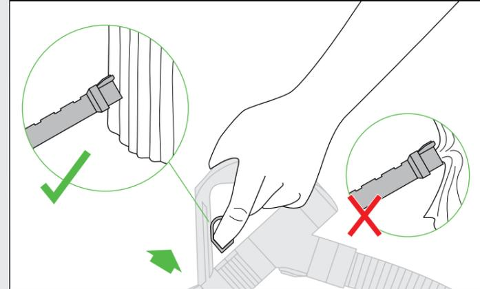
Emptying. Vidage. Behälterentleerung. Legen. Vaciado del cubo. Svootamento. Очистка контейнера. Praznjenje.
