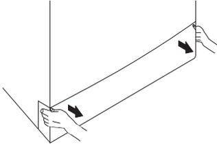
**i** Vous pouvez retirer le couvercle du filtre en poussant légèrement vers le bas à l'aide d'un mince objet pointu en plastique, par la fente située au-dessus du couvercle du filtre. Evitez d'utiliser des objets métalliques pointus pour enlever le couvercle.
