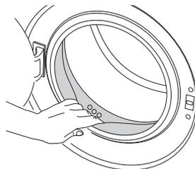
Si les orifices qui se trouvent sur le soufflet présenté dans le schéma ci-dessous sont obstrués, débloquez-les à l'aide d'un cure-dent.
