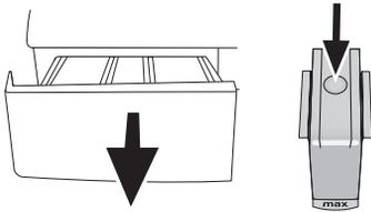
1. Appuyez sur le pointillé au-dessus du siphon dans le compartiment destiné à l'assouplissant, puis tirez vers vous jusqu'à ce que le compartiment soit enlevé de la machine.
