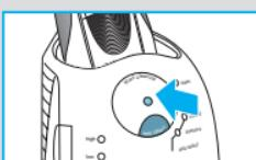
Under rengjøringen blinker den aktuelle rengjøringslampa. Hvert rengjøringsprogram består av flere sykluser, hvor rensevæsken skylles gjennom barberingshodet og en varmetørkingsprosess tørker barbermaskinen. Avhengig av det valgte programmet, vil den totale rengjøringstiden variere fra 32 til 43 minutter.
