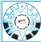
Una vez la lámina y bloque de cuchillas han sido cambiadas, con ayuda de un bolígrafo presionar el botón de reinicio ⑬ durante 3 segundos para poner el contador a cero.
