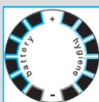
Rakapparatens display ⑯ visar batteriets laddningsstatus till vänster och hygienestatus till höger. (6 mörka indikatorer visas på var sida när batteriet är fulladdat och rakapparaten är hygieniskt ren).
