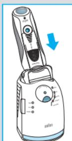
Antes del primer afeitado debe conectar al afeitadora a la red eléctrica usando el cable de conexión a la red eléctrica ⑯ o alternativamente proceder como se indica a continuación:
