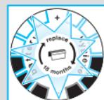
O sinal indicador de substituição lembrá-lo-á durante as próximas 7 utilizações que deverá substituir a cassette da lâmina e desbastador. Posteriormente, a máquina de barbear restaurará automaticamente o visor.
