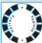
Barbermaskinens display ⑯ viser batteriets opladningsstatus til venstre og hygiestatus til højre. (6 mørke segmenter vises på hver side, når batteriet er fuldt opladt, og barbermaskinen er hygiensren).
