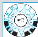
Udskiftningssymbolet minder dig under de næste syv barberinger om at udskifte kassetten til skæreblad og lamelkniv. Derefter nulstiller barbermaskinen automatisk displayet.
