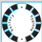
O visor da máquina de barbear <sup>14</sup> mostra no seu lado esquerdo o nível de carga da bateria, e no seu lado direito o nível de higiene. (Quando a bateria se encontra totalmente carregada, são visualizados 6 sinais escuros em ambos os lados e a máquina de barbear encontra-se limpa).
