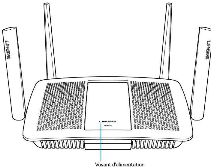
**Voyant d'alimentation :** le voyant du logo Linksys reste allumé en continu lorsque le routeur est connecté à Internet. Clignote lentement lors du démarrage, de l'auto-évaluation et des mises à niveau du micrologiciel. Clignote rapidement pour signaler des erreurs de connexion.
