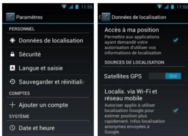
**Astuce:** Pour accélérer le positionnement en milieu urbain, activez le mode Wi-Fi en plus du mode GPS. L'activation du mode Wi-Fi permettra au téléphone de lire la position géographique à partir des bornes Wi-Fi à portée.
