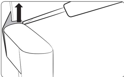
1. Soulevez le crochet intérieur à l'aide d'un tournevis à tête plate.
