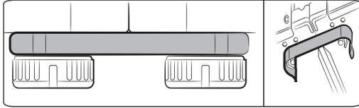
**5.** Installez le composant PIED DE RENFORT-BAS à l'emplacement du pied, en bas du réfrigérateur.
