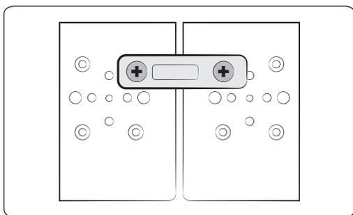
3. Reliez et serrez les côtés supérieurs des deux réfrigérateurs à l'aide du crochet de fixation fourni et des vis.
