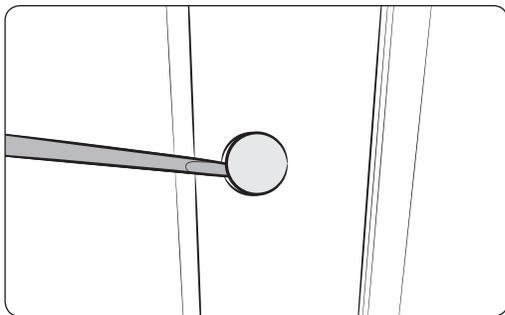
5. Retirez deux protections (supérieure et inférieure) autour de la poignée à l'aide d'un tournevis à tête plate.
