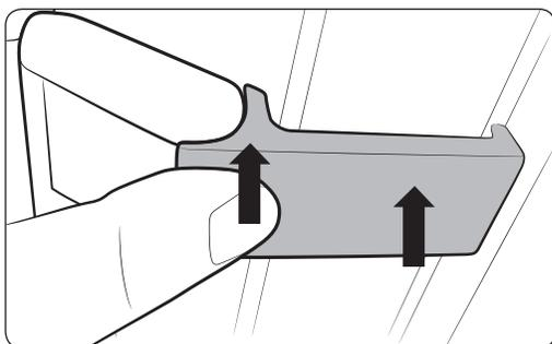
7. Remettez le cache en place du crochet intérieur en veillant à ce qu'il soit parfaitement inséré. (il en est de même pour le crochet extérieur)
