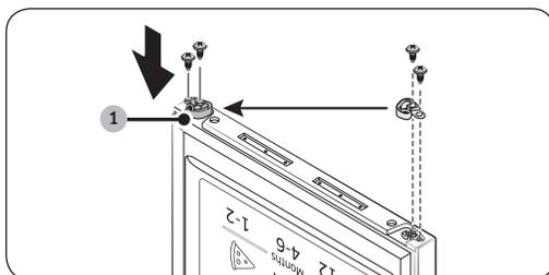
1. Sur la porte du congélateur, retirez le **levier de fermeture automatique (1)** en dévissant les vis du levier et les vis du côté opposé.
