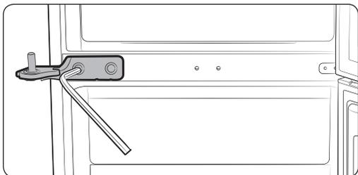
8. Assemblez la charnière centrale à l'aide de la clé hexagonale de 5 mm. Tout d'abord, assemblez la porte du congélateur et la charnière centrale. Puis assemblez la charnière inférieure et la porte du congélateur avec la charnière supérieure.
