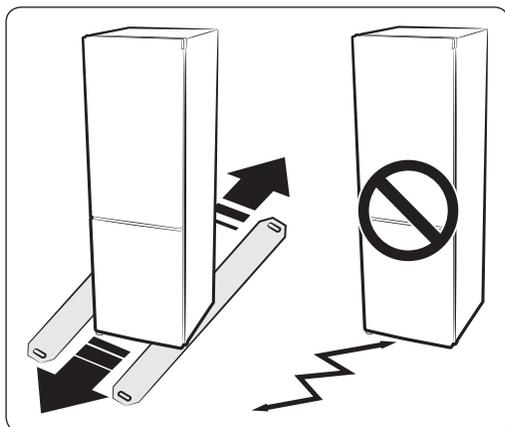
Pour une installation correcte, ce réfrigérateur doit être placé sur une surface plane et dure située au même niveau que le reste du sol. Cette surface doit être suffisamment résistante pour supporter le poids d'un réfrigérateur plein. Afin de protéger la finition du plancher, coupez un grand morceau de carton et placez-le sous le réfrigérateur, à l'endroit où vous travaillez.
