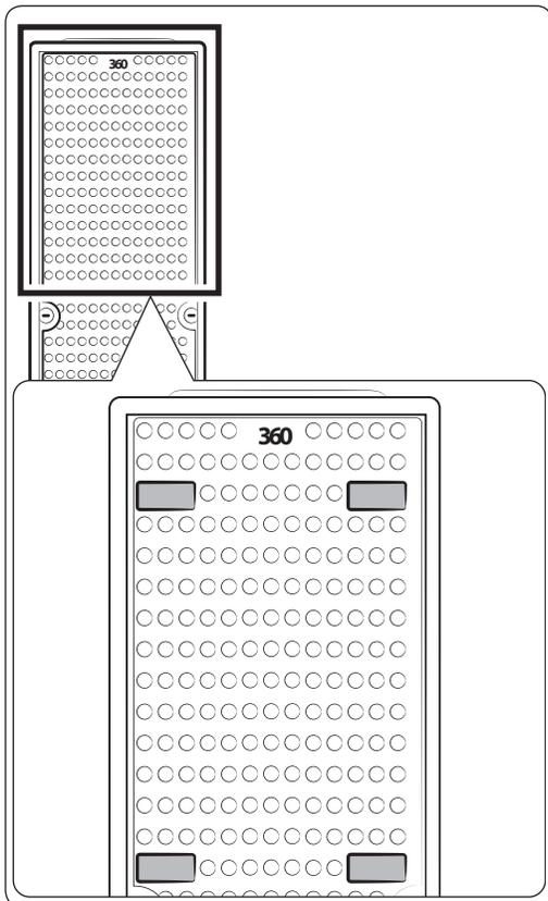
2. Placez la mousse PE fournie en 4 endroits, à l'arrière du produit.
