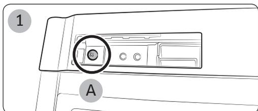
**11.** Après avoir démonté la commande sur le cache ( 1 ), retournez la direction du volet de protection des câbles ( 2 ) sur le côté opposé sur la porte du réfrigérateur (uniquement pour les modèles avec affichage sur la porte). Montez la commande sur le cache ( A ) avec une vis comme indiqué sur la figure ( 3 ).
