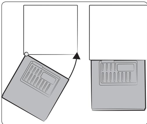
3. Alignez le bord gauche du produit sur la paroi gauche du châssis, puis orientez le côté droit du produit vers la paroi droite du châssis, comme indiqué.
