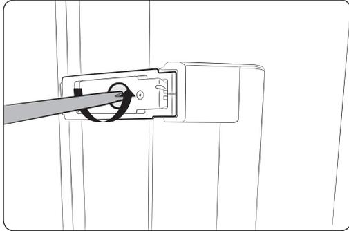
4. Desserrez deux vis (supérieure et inférieure) à l'aide d'un tournevis cruciforme pour retirer la poignée.
