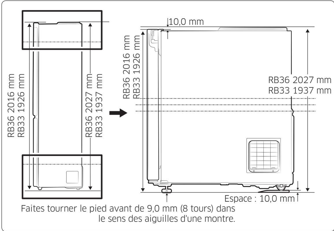
Installation du dispositif de fixation dans la cuisine (modèles RB33/36\*)
