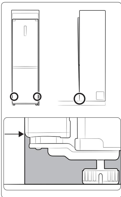
4. Insérez le produit dans le châssis, de sorte que le fond du premier soit aligné sur le fond de ce dernier.
