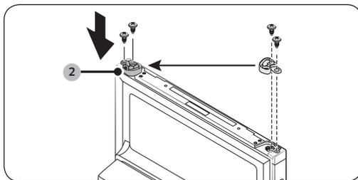
1. Sur la porte du congélateur, retirez le **levier de fermeture automatique (2)** en dévissant les vis du levier et les vis du côté opposé.
