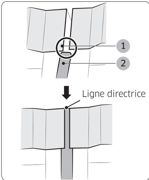
**6.** Insérez le DISPOSITIF DE FIXATION entre les deux réfrigérateurs. Utilisez un tournevis à tête plate pour créer un interstice dans le cache ( 1 ), puis insérez le DISPOSITIF DE FIXATION ( 2 ).
