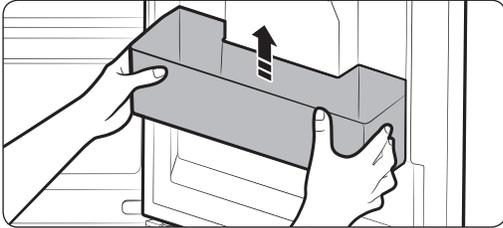
Saisissez fermement les barres de retenue de la porte avec les deux mains et soulevez-les légèrement pour les retirer.
