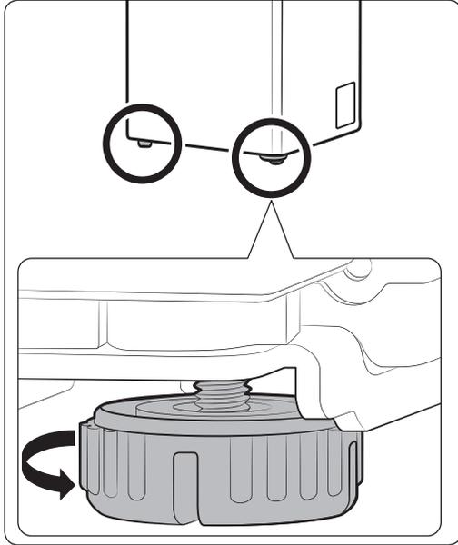
1. Faites tourner le pied sur 9,0 mm (8 tours) dans le sens des aiguilles d'une montre afin de le desserrer.
