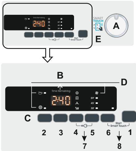
**A-Auswahlanzeige** - Der Knopf kann in beide Richtungen gedreht und damit das gewünschte Trocknungsprogramm ausgewählt werden. Drehen Sie den Knopf zum Ausschalten des Trockners oder zum Löschen auf AUS (OFF).
