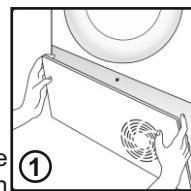
2. Gire el bloqueo de dos palancas en sentido anti-horario y tire de la parte delantera
