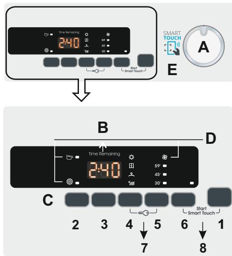
**A- Manopola** - Ruotando la manopola in entrambe le direzioni è possibile selezionare il programma di asciugatura desiderato. Per annullare il programma selezionato o spegnere l'asciugatrice, ruotare la manopola in posizione OFF.
