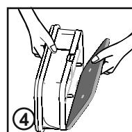
5. Passen Sie den Kondensatordeckel wieder ein (Richtung wird durch den Pfeil angegeben) und stellen Sie sicher, dass er fest an seinen Platz gedrückt wird. Schließen Sie die zwei Verschlusshebel durch eine Drehung im Uhrzeigersinn.
