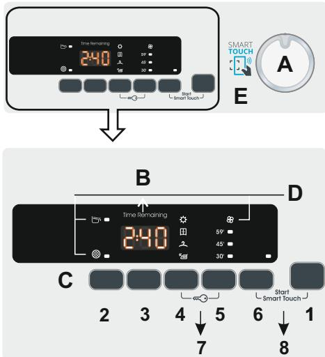
**A- Cyclus selecteren -** U kan de knop in beide richtingen draaien om het gewenste droogprogramma te selecteren. Om de selectie te annuleren of om de droger stop te zetten, draait u de knop op OFF.
