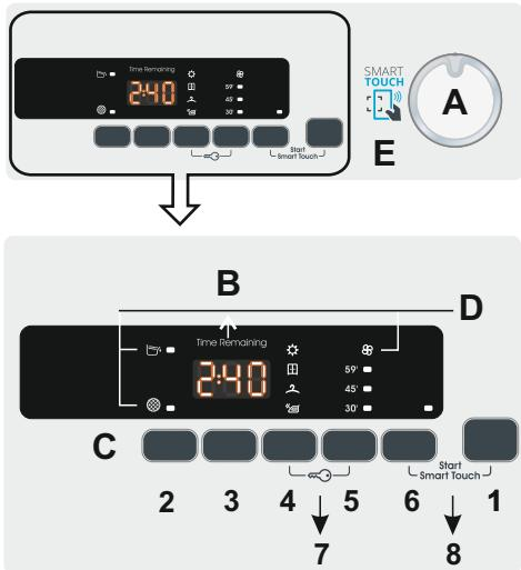
**A-Selector de programa** - Girando el mando en ambas direcciones es posible seleccionar el programa de secado deseado. Para cancelar las selecciones o apagar la secadora gire el mando hacia OFF.
