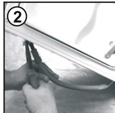
3.Koppel de slang los van de brug-verbinding
