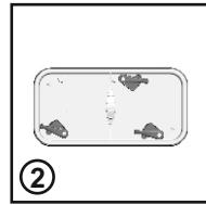
3. Nehmen Sie vorsichtig den Filterrahmen heraus und entfernen Sie etwaigen Staub oder Flusen vorsichtig mit einem Tuch. Reinigen Sie den Filter nicht mit Wasser.
