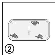
3. Retire e cuidadosamente a moldura do filtro e limpe todo o pó ou cotão do filtro com um pano. Não use água para limpar o filtro.
