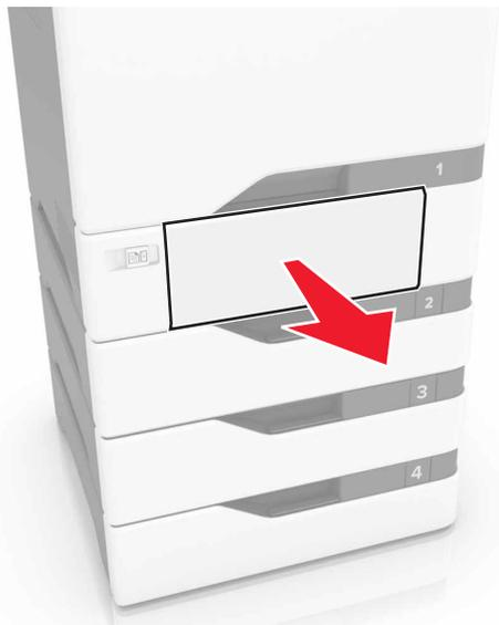
**Attention — Dommages potentiels :** Un capteur dans le tiroir facultatif peut facilement être endommagé par l'électricité statique. Touchez une surface métallique avant de retirer le papier coincé dans le tiroir.
