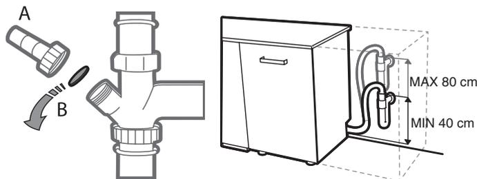
Avant de brancher le tuyau de sortie à l'évier, assurez-vous d'enlever le bouchon de plastique **B**.
