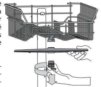
Pour enlever le bras d'aspersion supérieur, tournez l'anneau de verrouillage en plastique dans le sens antihoraire. Le bras d'aspersion supérieur doit être replacé de façon que le côté avec le plus grand nombre de trous est placé vers le haut.
