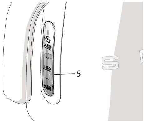
L'indicateur indique les différents niveaux de remplissage de l'eau, d'un minimum de 0,5 litre à un maximum de 1,7 litre ainsi que le nombre de tasses correspondant.
