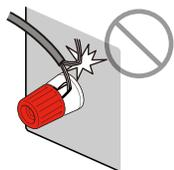
Si « Check SP Wires » apparaît sur l'afficheur de la face avant à la mise sous tension de l'unité, éteignez-la, puis vérifiez que les câbles d'enceinte ne sont pas court-circuités.
