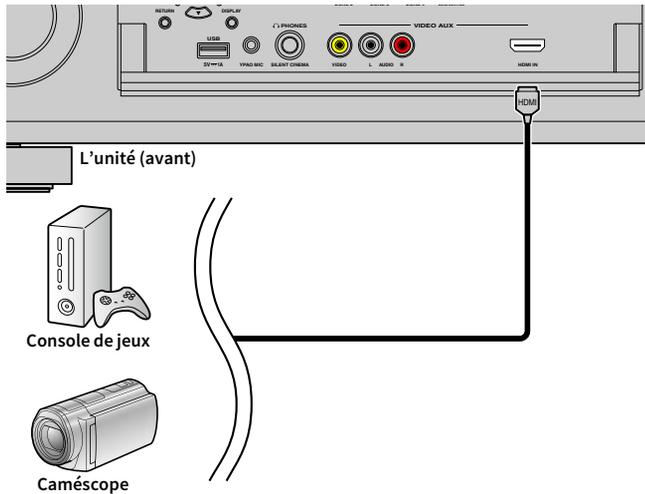
Si vous appuyez sur V-AUX pour sélectionner la source d'entrée « V-AUX » sur la télécommande, les signaux vidéo/audio lus par l'appareil seront restitués sur l'unité.
