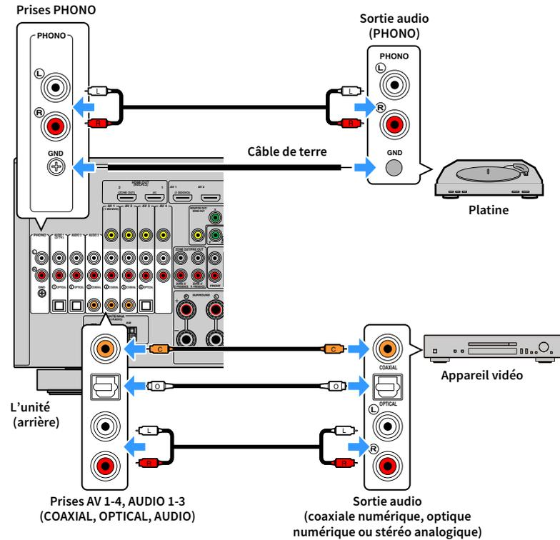
Si vous appuyez sur AV 1-4, AUDIO 1-3 ou PHONO sur la télécommande pour sélectionner la source d'entrée, les signaux audio lus par l'appareil audio seront restitués sur l'unité.
