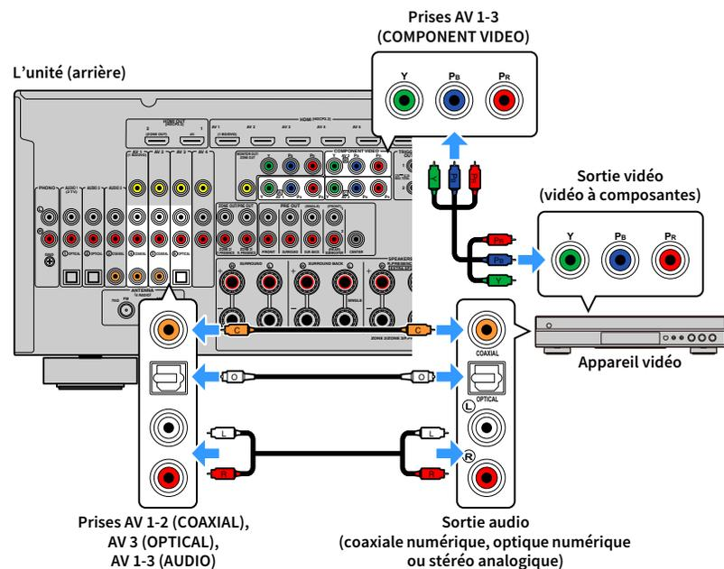
Si vous appuyez sur AV 1-3 sur la télécommande pour sélectionner la source d'entrée, les signaux vidéo/audio lus par l'appareil vidéo seront restitués sur l'unité.
