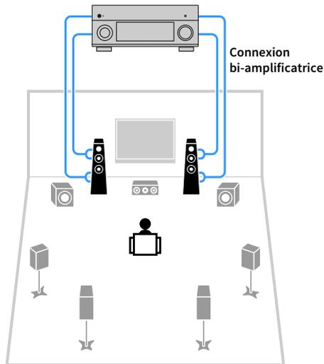
Combinaison d'un amplificateur de puissance externe (amplificateur hi-fi, multi-voies ou autre) pour créer un système étendu
