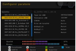
B) L'écran **Configurer parabole** s'affiche alors sur votre TV. Sélectionnez le satellite pointé par votre parabole et vérifiez le **Niveau** et la **Qualité** du signal. Une qualité à 00% signifie que le satellite sélectionné ne correspond pas à celui pointé par votre parabole.
