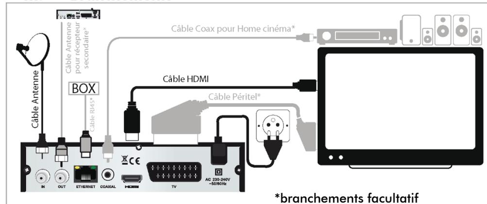
**Attention :** Pour utiliser la sortie parabole OUT, vous devez disposer d'une parabole équipée d'une tête LNB spécifique. Contactez un professionnel.
