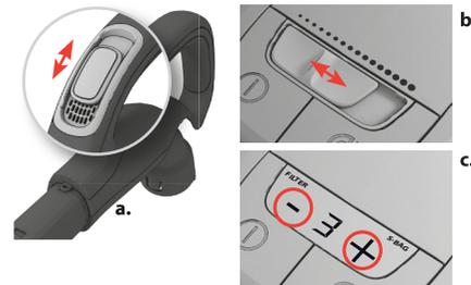
**bul** 7. Включване/изключване на прахосмукачката чрез натискане на бутона ВКЛ./ИЗКЛ (ON/OFF).
