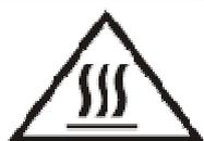
La température des surfaces accessibles (porte et surface extérieure) peut être élevée lorsque l'appareil fonctionne. Ce logo signifie que la partie où il est apposé peut devenir très chaude pendant le fonctionnement de l'appareil.
