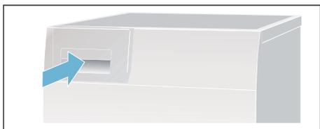
**Remarque :** Le filtre du réservoir d'eau de condensation filtre l'eau de condensation utilisée pour le nettoyage automatique de votre sèche-linge. Le filtre est nettoyé en vidant l'eau de condensation. Vérifiez régulièrement
