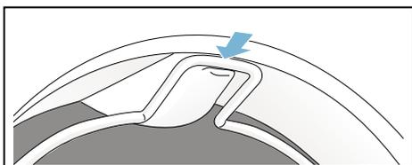
Le panier à lainages doit maintenant être fixé solidement dans le tambour du sèche-linge.
