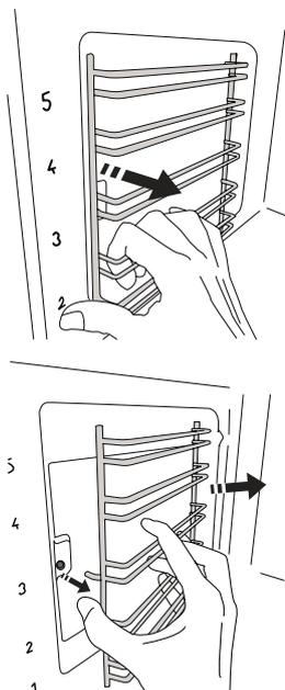
• **Pour remplacer les supports de grille**, placez-les près de la cavité et insérez en premier les deux goupilles dans leur appui. Ensuite, placez la partie externe près de son appui, insérez le support, et appuyez fermement vers la paroi pour s'assurer que le support est bien inséré.
