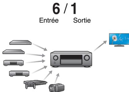
Cet appareil est équipé de 6 entrées HDMI et de 1 sortie HDMI permettant la connexion à divers appareils compatibles HDMI tels que des lecteurs Blu-ray Disc, des consoles de jeux et des caméscopes HD.
