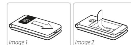
**Image 1** : retirer le couvercle de la batterie
