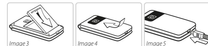
**Image 3** : insérer la batterie, les contacts de la batterie doivent toucher les contacts dorés du téléphone portable.
