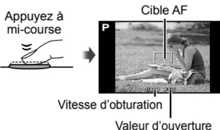
**5** Pour prendre la photo, enfoncez doucement le déclencheur jusqu'au fond, en prenant soin de ne pas secouer l'appareil photo.
