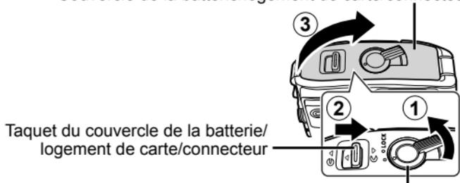
**2** Insérez la batterie tout en faisant glisser la touche de verrouillage de la batterie dans le sens de la flèche.
