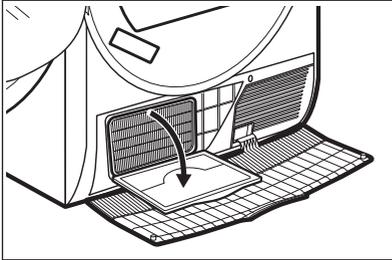
5. Si nécessaire, retirez les peluches sur le condenseur et dans son compartiment. Vous pouvez utiliser un chiffon humide et/ou un aspirateur avec brosse.
