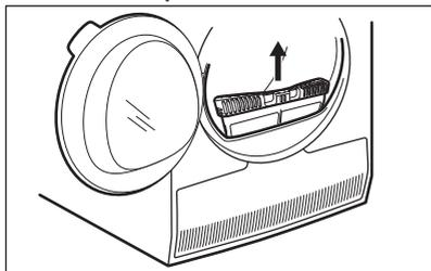
2. Poussez sur le crochet pour ouvrir le filtre.
