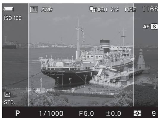
Lorsque vous photographiez avec un ratio d'image différent de 3:2, le cadre est normalement opaque. En le rendant semi-transparent, il est possible de l'utiliser comme un Affichage Mode Sport qui permet aux utilisateurs de visualiser la périphérie de l'image.
