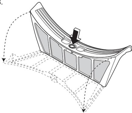
Ouvrez le filtre en appuyant sur le bouton entre les deux fentes des joints. Nettoyez le filtre à l'aide d'un chiffon humide. Après un certain temps, les filtres se couvrent d'une patine due aux résidus de lessive sur le linge. Pour éliminer cette patine, nettoyez le filtre à l'eau chaude en le frottant à l'aide d'une brosse. Fermez le filtre et n'oubliez pas de le remettre en place.
