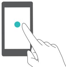
**Appuyez sur** : Appuyez une fois sur un élément. Par exemple, appuyez pour sélectionner un élément ou ouvrir une application.
