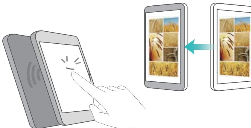
Vérifiez que l'écran est déverrouillé et que le NFC est activé sur les deux téléphones. Activez Android Beam sur l'autre téléphone (si nécessaire).
