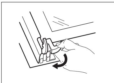
5. Débloquez le système de verrouillage afin de retirer les panneaux de verre.
