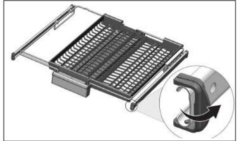
Lorsque le plateau central est en position basse, vous pouvez charger des objets longs et hauts tels que les tasses de café, les louches, etc. sur le plateau. Lorsque les plateaux latéraux reposent sur deux parois latérales, vous pouvez tirer la poignée pour permettre au plateau central de se soulever et de verrouiller le système.
