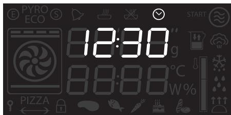
**ON :** Lorsqu'on a démarré une fonction quelconque, l'afficheur indique les paramètres sélectionnés pour la température, la durée, la puissance des micro-ondes et la température atteinte.
