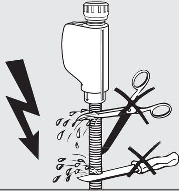
⚠ Le tuyau d'arrivée ne doit pas être raccourci ou abîmé étant donné qu'on y trouve des éléments sous tension (voir croquis).
