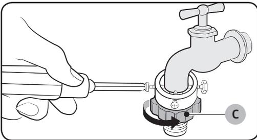
4. Insérez l'adaptateur dans le robinet d'eau, et resserrer les vis tout en levant l'adaptateur.
