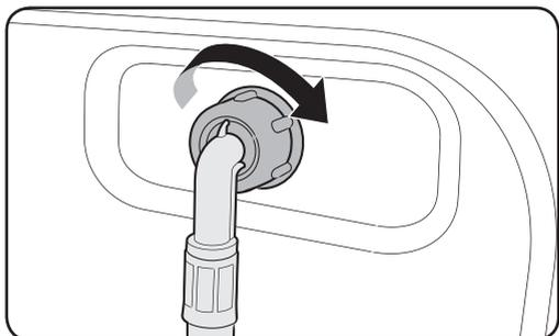
8. Raccordez l'autre extrémité du tuyau d'arrivée d'eau à la vanne d'alimentation en eau située à l'arrière du lave-linge. Tournez le tuyau dans le sens horaire pour resserrer.
