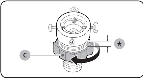
3. Tenez l'adaptateur et tournez la partie (C) dans le sens de la flèche pour le desserrer de 5 mm (\*).
