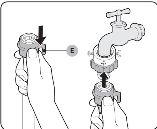
6. Tout en maintenant la **partie (E)** vers le bas, raccordez le tuyau d'arrivée d'eau à l'adaptateur. Puis, relâchez la **partie (E)**. Le tuyau s'adapte dans l'adaptateur en émettant un clic.
