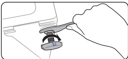
1. Mettez le lave-linge en place en le faisant glisser doucement. Une pression excessive peut endommager le pied de mise à niveau.
