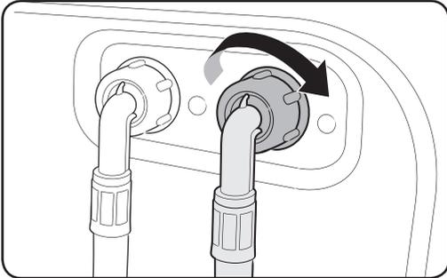
1. Raccordez l'autre extrémité du tuyau d'arrivée d'eau chaude à la vanne d'alimentation en eau chaude située à l'arrière du lave-linge.
