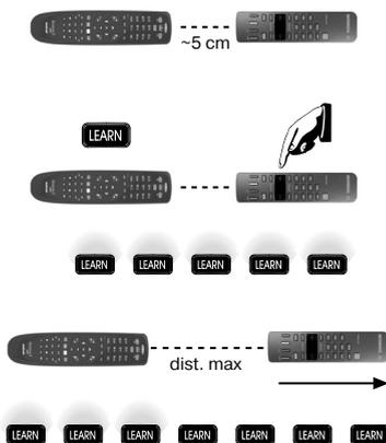
Pour procéder à l'apprentissage des signaux, vous devez rapprocher la télécommande d'origine jusqu'à la moitié de la distance maximale trouvée en gardant le même alignement. Ne bougez plus les télécommandes jusqu'à la fin de la procédure.
