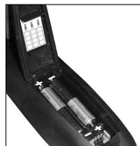
**Il est conseillé de ne pas laisser des piles usagées dans la télécommande, celles-ci pourraient couler et l'endommager**
