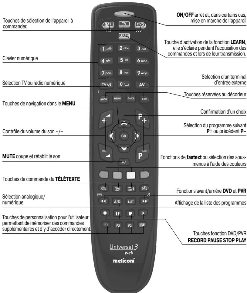
**Avant d'utiliser la télécommande, insérez les piles et programmez-la.**
