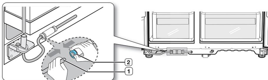
2. Le tuyau d'eau doit être inséré jusqu'au centre du coupleur transparent afin d'éviter toute fuite d'eau au niveau du distributeur.
