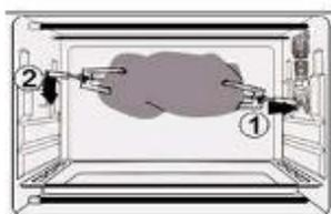
Insérez les fourches du tournebroche dans l'orifice du tournebroche, puis installez le plateau du tournebroche.
