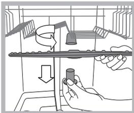
Pour démonter le bras supérieur, il faut dévisser sa bague en plastique en tournant dans le sens inverse des aiguilles d'une montre. Remonter le bras gicleur supérieur en veillant à ce que la face percée du plus grand nombre d'orifices soit bien orientée vers le haut.
