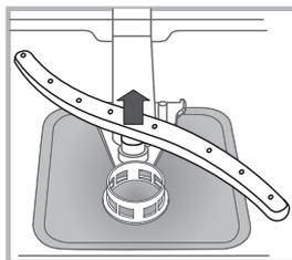
Pour démonter le bras de lavage inférieur, pousser sur les languettes situées sur les côtés et tirer vers le haut.
