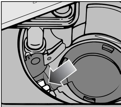
Sous le clapet anti-retour se trouve la pompe de vidange (flèche).
