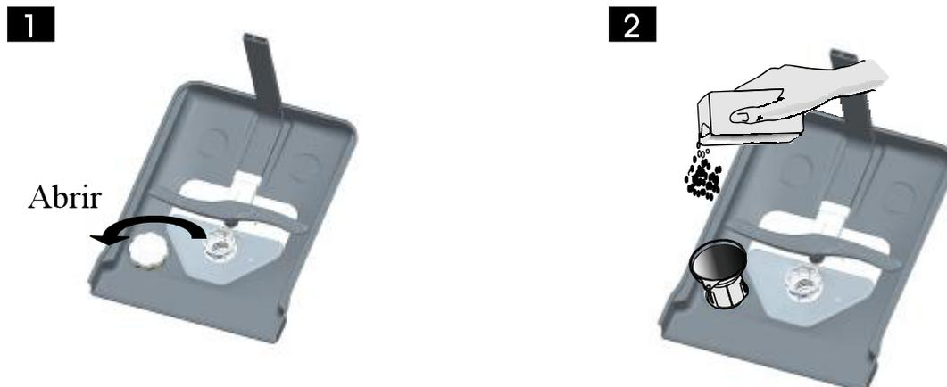
A Retire la cesta y entonces desenrosque y saque la tapa del depósito de la sal.. **1**
