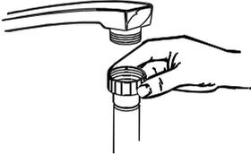
Conecte el tubo de suministro de agua fría a un conector roscado de  $\frac{3}{4}$  (pulgadas) y asegúrese de que está bien precintado apretado y colocado
