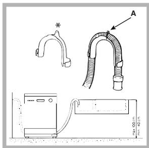
El codo\* de plástico especial facilita una colocación óptima: fije firmemente el codo a la pared para evitar que el tubo se mueva y vierta agua fuera de la descarga.
