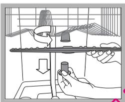
Per smontare l'irroratore superiore, occorre svitare girando in senso antiorario la ghiera di plastica. L'irroratore superiore va rimontato con la parte con il maggior numero di fori rivolta verso l'alto.
