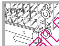
Aprire i fermi delle guide del cesto a destra e a sinistra ed estrarre il cesto; sistemarlo in alto o in basso, farlo scivolare lungo le guide fino a far entrare anche le rotelle anteriori e chiudere i fermi (vedi figura).
