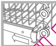
Abra los sujetadores de las guías del cesto a la izquierda y a la derecha, y extráigalo; colóquelo arriba o abajo, hágalo deslizar a lo largo de las guías hasta hacer entrar también las ruedas delanteras y cierre los sujetadores (ver
