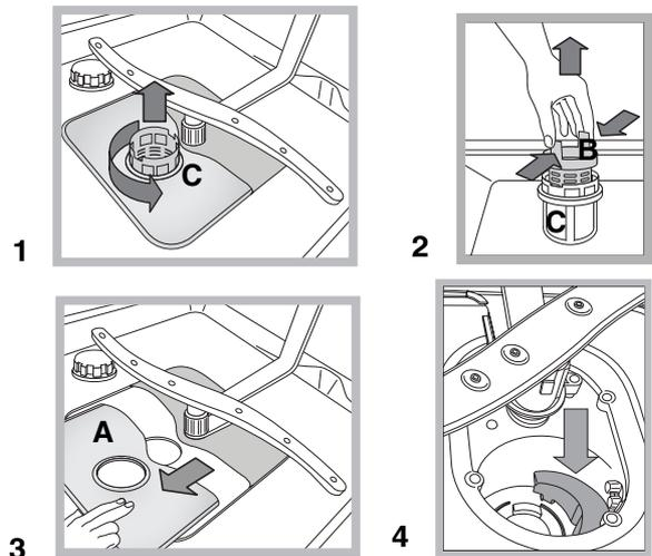
Na het reinigen van de filters dient u de filtergroep weer op zijn plaats te zetten. Dit is fundamenteel voor een goede werking van de afwasautomaat.
