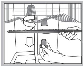
Para desmontar o aspersor superior deve-se desapeitar girando o aro de plástico na direcção anti-horária. O braço aspersor superior deve ser remontado com os furos para cima.
