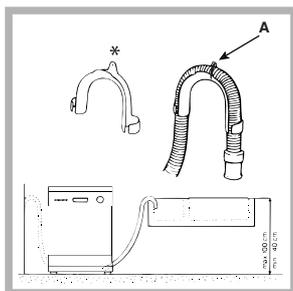
Lo speciale gomito\* in plastica agevola una sistemazione ottimale: fissare saldamente il gomito al muro per evitare che il tubo si muova e versi l'acqua fuori dallo scarico. La parte del tubo contrassegnata con la lettera A deve essere a
