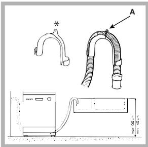
Der spezielle Kunststoffbügel\* erleichtert Ihnen eine optimale Anbringung. Befestigen Sie den Kunststoffbügel so an der Mauer, dass er nicht verrutscht und somit kein Wasser außerhalb des Ablaufs austritt. Der mit dem Buchstaben A versehene Schlauchteil muss auf einer Höhe von 40 - 100 cm vom Boden liegen (siehe
