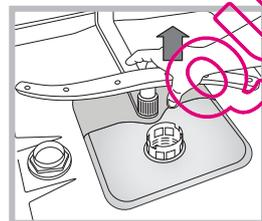
Der untere Sprüharm wird nach oben abgezogen.
