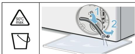
5. Dévissez délicatement le bouchon de la pompe, de l'eau résiduelle peut s'écouler. Nettoyez le compartiment intérieur, le filetage du couvercle de pompe et le carter de pompe. Le rotor de la pompe de vidange doit pouvoir tourner librement. Remettez le couvercle en place et vissez-le. Il faut que la poignée se trouve à la verticale.
