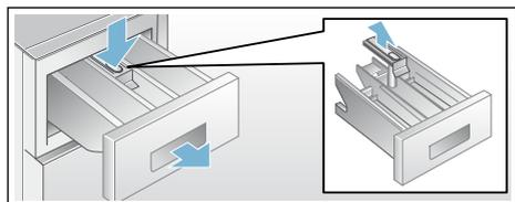
3. Avec de l'eau et une brosse, nettoyez le bac d'introduction du produit et l'insert, puis séchez-les. Nettoyez le boîtier aussi à l'intérieur.
