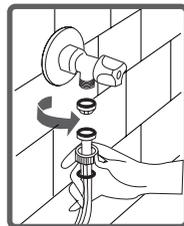
• Un débit d'eau à une pression de 0,1-1 Mpa permettra un fonctionnement optimal de votre machine. (Une pression de 0,1 Mpa montre que plus de 8 litres d'eau s'écoulent par minute, sous un robinet entièrement ouvert.)
