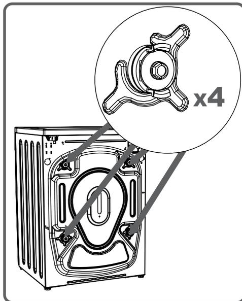
Pour cette raison, les vis de bridage doivent être desserrées par rotation dans le sens antihoraire à l'aide d'une clé appropriée.
