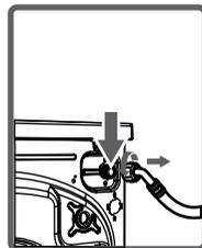
• Raccordez l'extrémité à coude blanc des tuyaux d'arrivée d'eau au robinet d'arrivée d'eau à filtre blanc sur la face arrière de la machine et l'extrémité à coude rouge au robinet à filtre rouge (pour les machines à arrivée d'eau double). Serrez à la main les pièces en plastique des jonctions. Dans des conditions incertaines, faites effectués les travaux de raccordement par un plombier qualifié.
