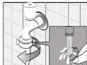
Sie können ebenfalls den Filter am Wasserzulaufstutzen der Waschmaschine reinigen:
