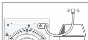
Schrauben Sie die Anschlussmuffe des Zulaufschlauchs, der dem Gerät beiliegt, auf das Gewindestück des Wasserhahns (20x27). Schrauben Sie die Muffe gut fest, um ein Austreten von Wasser zu verhindern. Benutzen Sie hierfür nie einen bereits gebrauchten Schlauch.
