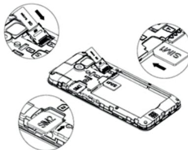
3. Si vous possédez une deuxième carte SIM, faites-la glisser dans l'emplacement de gauche SIM 2 comme indiqué sur le schéma dans l'appareil.
