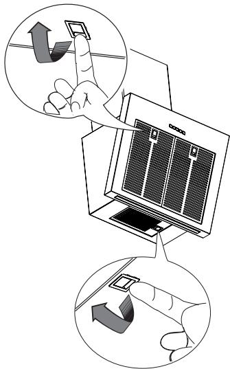
**Sostituzione delle lampade**
